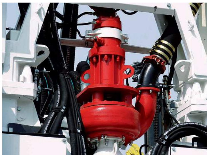
Специальное исполнение "Habermann" - "KBKT-V1" с гидравлическим приводом, оснащающий траншеекопатели ведущих европейских специализированных производителей
